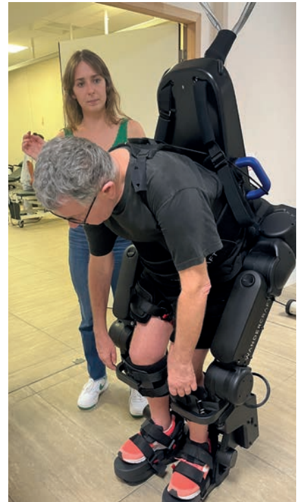
Exosquelette utilisé lors d'une séance de rééducation.
